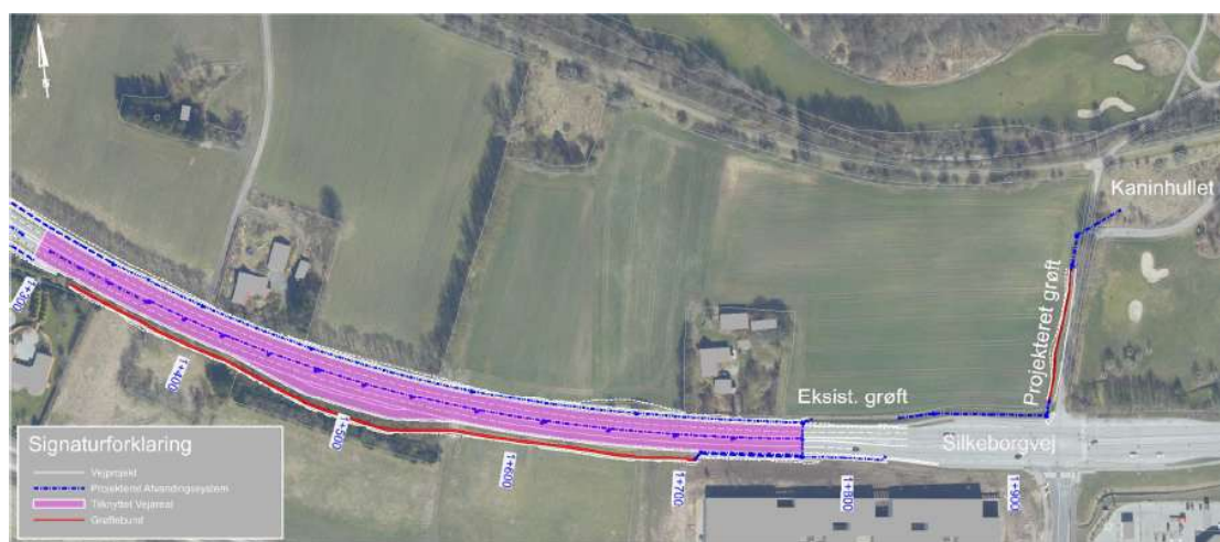
Figur 2: Det tilknyttede vejareal hvorfra vandet føres i grøft til nedsivning i Kaninhullet.
