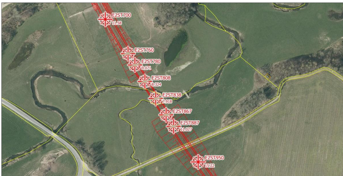
Figur 3.1. Oversigt over placering af geotekniske borer.
