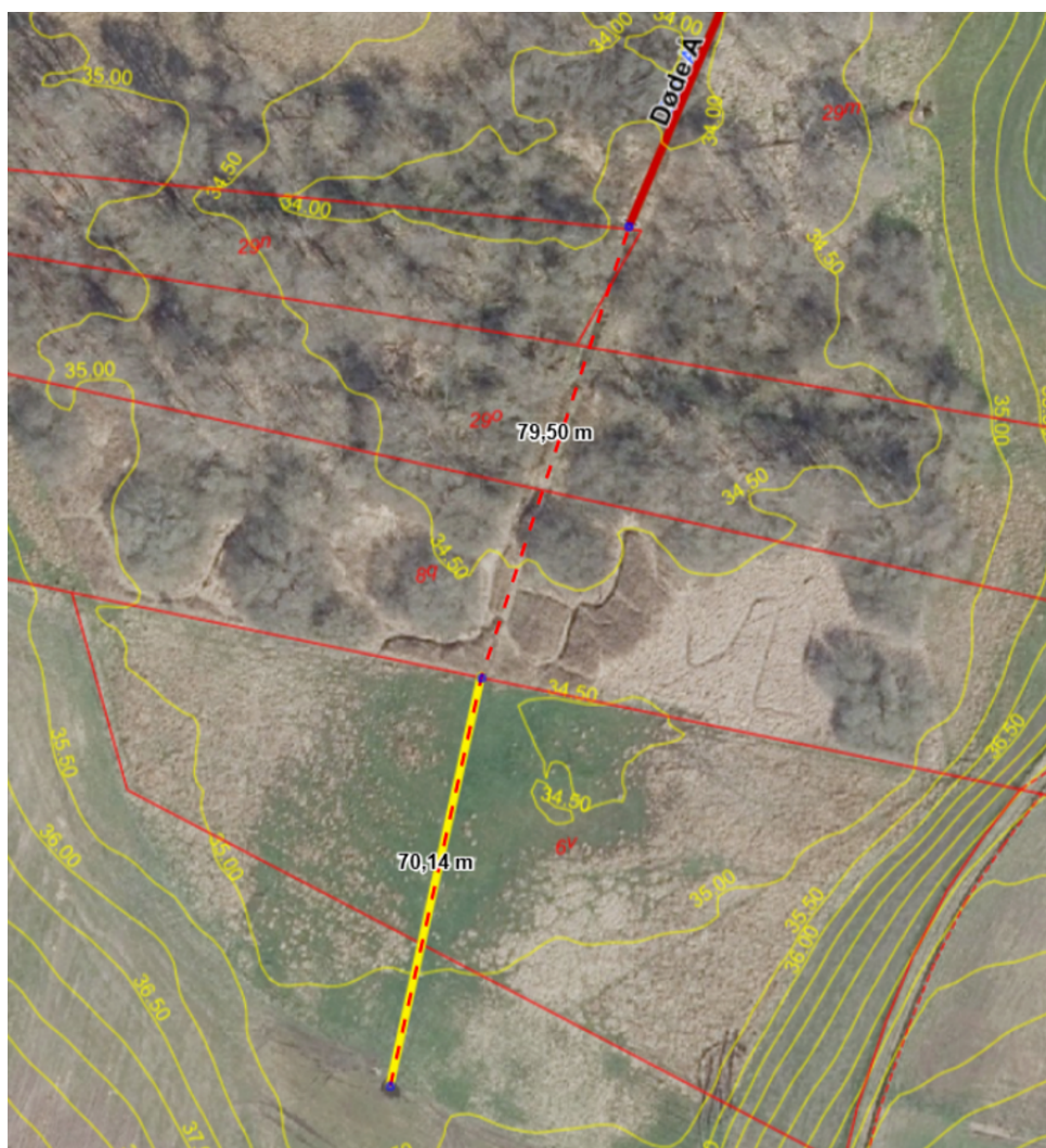
Kort 1. Luftfoto 2026 ©GeoDanmark. Dræn der ønskes åbnet, er markeret med gul streg. Matrikelgrænser er markeret med rød streg og højdekurver med tynd gul streg.
