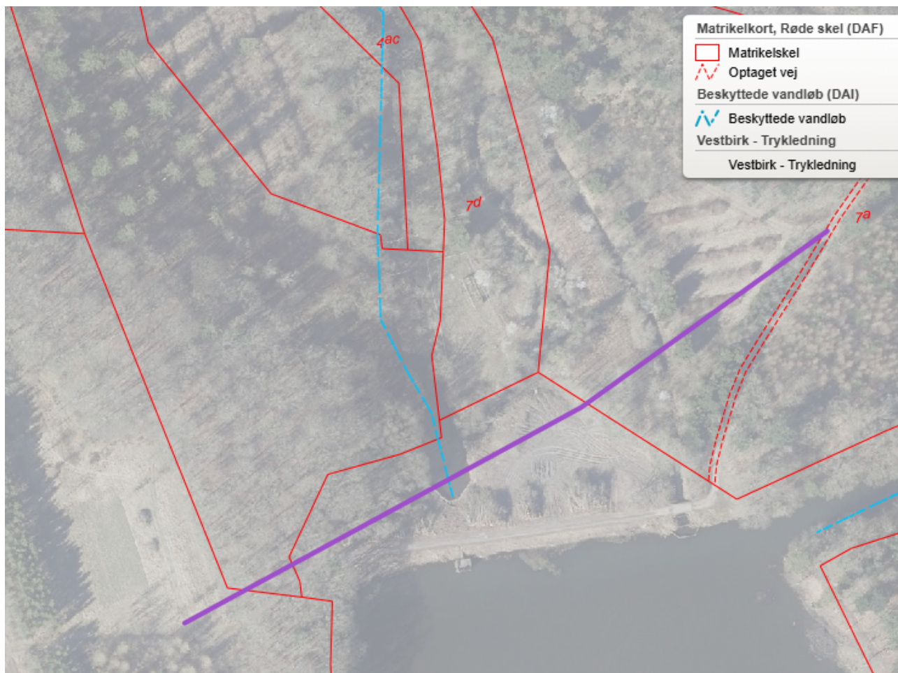
Figur 1. Luftfoto 2025. CC BY GeoDanmark. Oversigt over ledningens placering på tværs af Gudenaåen.
