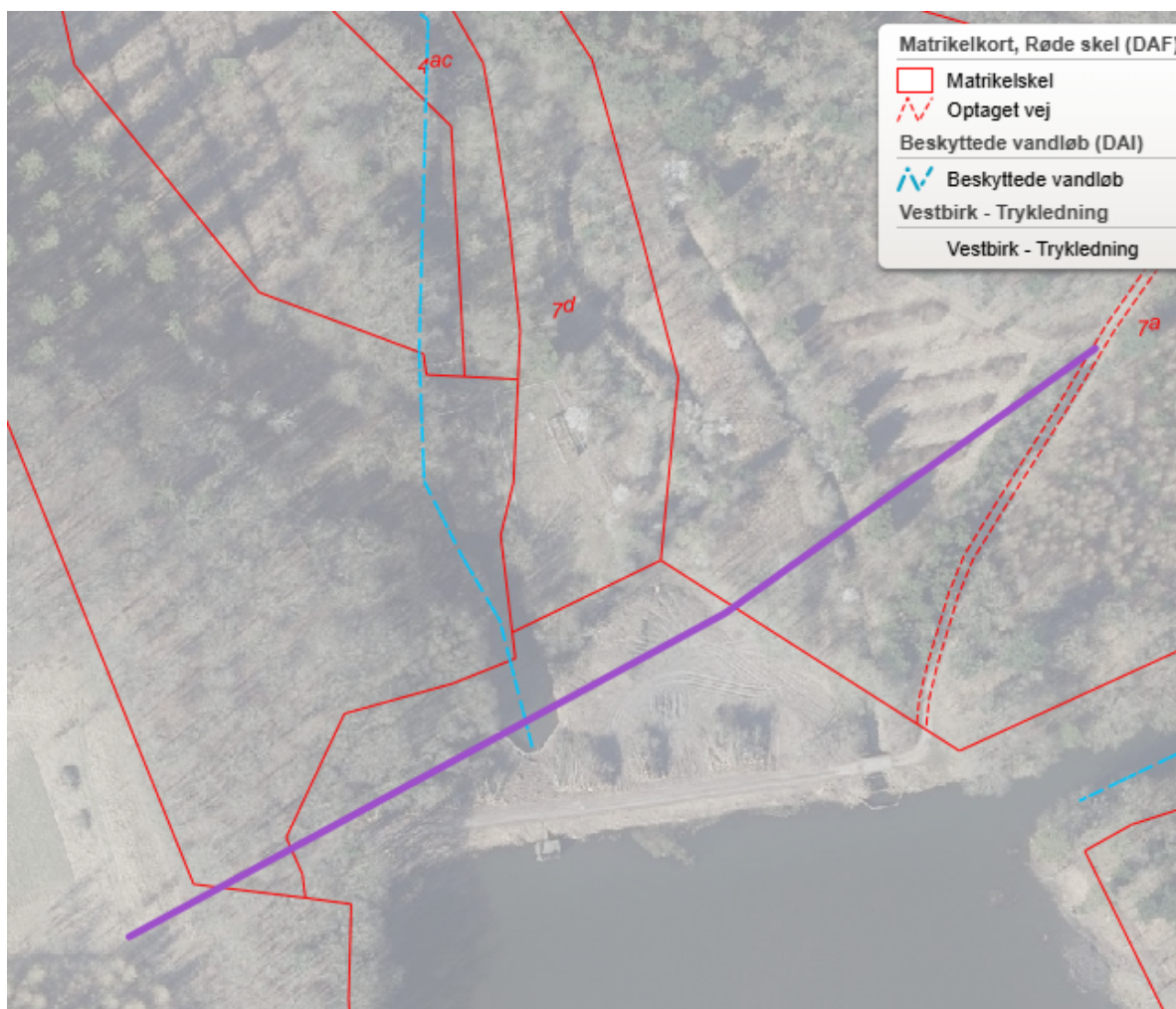
Figur 1. Luftfoto 2025. CC BY GeoDanmark. Oversigt over ledningens placering på tværs af Gudenaåen. Trykvandsledningens fremtidige placering fremgår med lilla streg.
