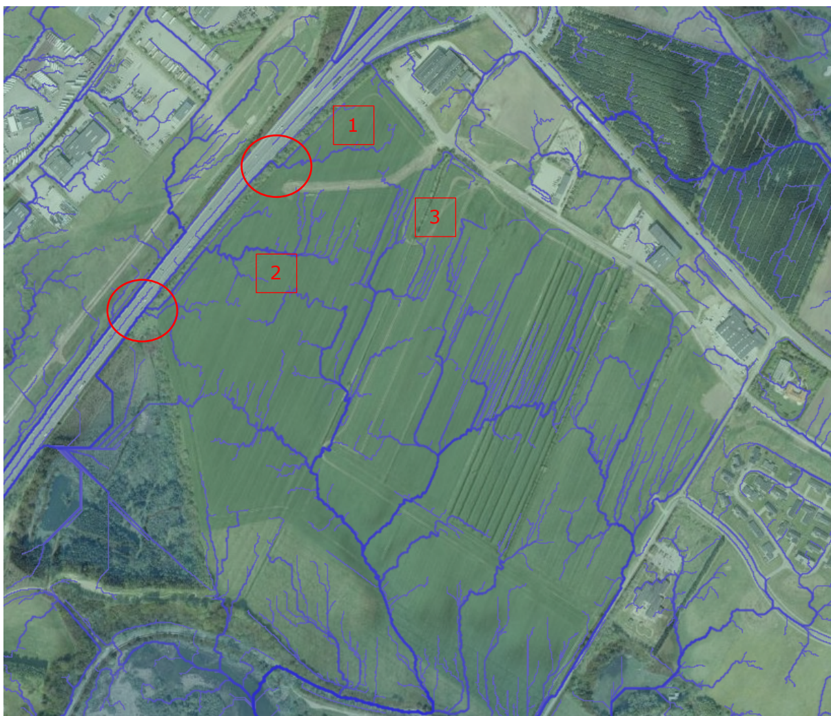
Figur 8: Udsnit af de eksisterende strømningsveje for området. De tre væsentligste strømningsretninger for projektet er angivet med nummeringen 1 til 3. Med rød cirkel er angivet, hvor strømningsvej løber ned ad skrænt mod motorvejsareal.
