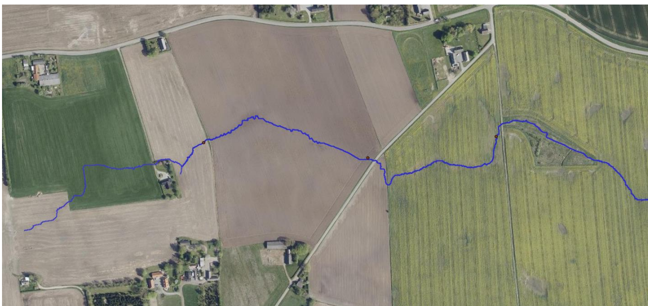
Figur 3. Kortudsnit fra SCALGO Live, der viser placeringen af potentielle minivådområder. I kuperede landskaber vil placeringer af drænedninger oftest være sammenfaldende med strømningsveje. Der er vist flere forslag til placering langs strømningsvejen, selvom der kun kan søges tilskud til at gennemføre ét projekt for hvert drænoiland.
