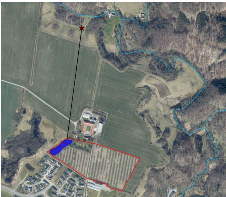
Figur 1: Afgrænsning af byggemodningen Egebjerggårdsvej, Etape 3, markeret med rødt. Skitsering af regnvandsbassin A765BR er vist med blå, og nyt udløb A765UR er vist med stjerne. Tolstrup Å er markeret med stiplede lys blå.
