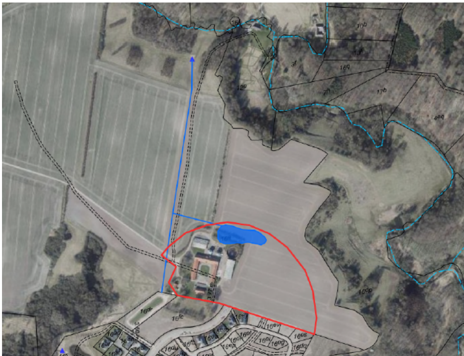
Figur 1: Oversigtskort. Projektområdet er indrammet med rødt. Regnvandsbassin A767BR er markeret med blåt. Eksisterende afløbsledning og ny afløbsledning fra bassin A767BR er markeret med en blå streg. Eksisterende udløb A765UR er markeret med en blå streg
