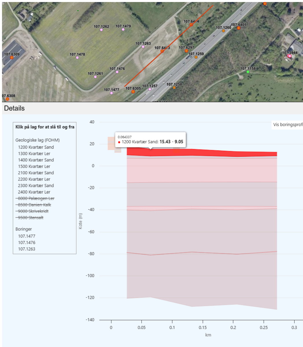
Figur 8. Tværsnit gennem bassin med FOHM lag.
