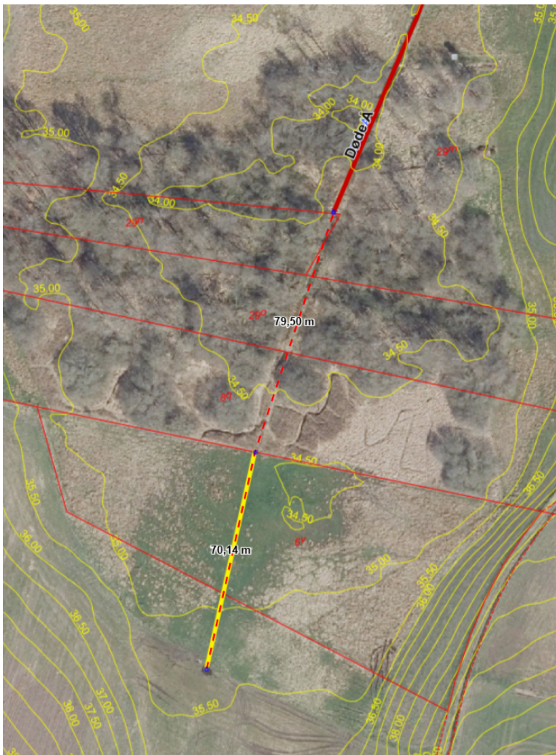
Figur 1 Drænen der ønskes åbnet, er markeret med en gul streg (ca. 70 meter).
