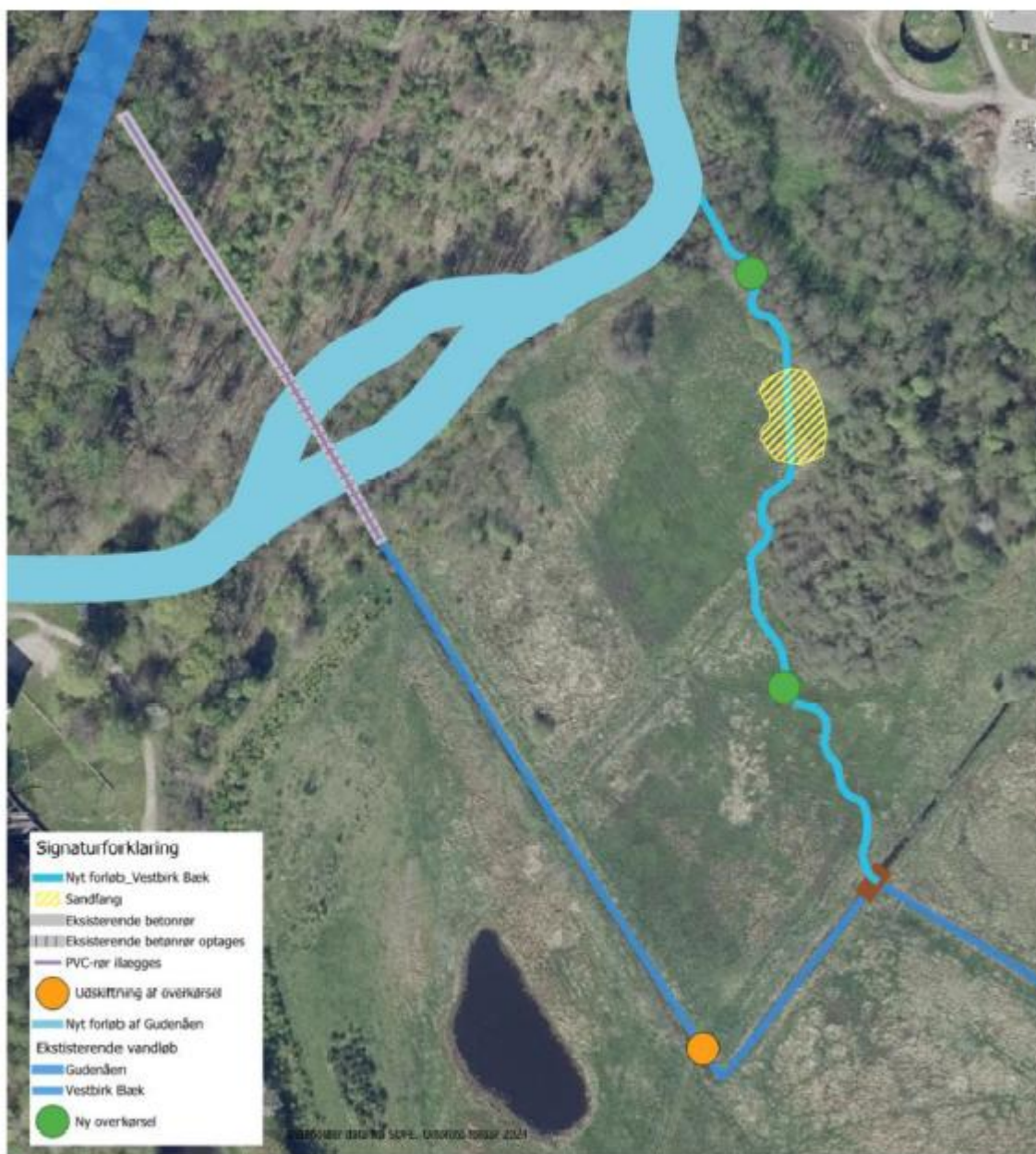
Figur 1. Nyt forløb af Vestbirk Bæk med etablering af sandfang på strækningen. Nuværende forløb af Vestbirk Bæk anvendes fremadrettet til afvanding.
