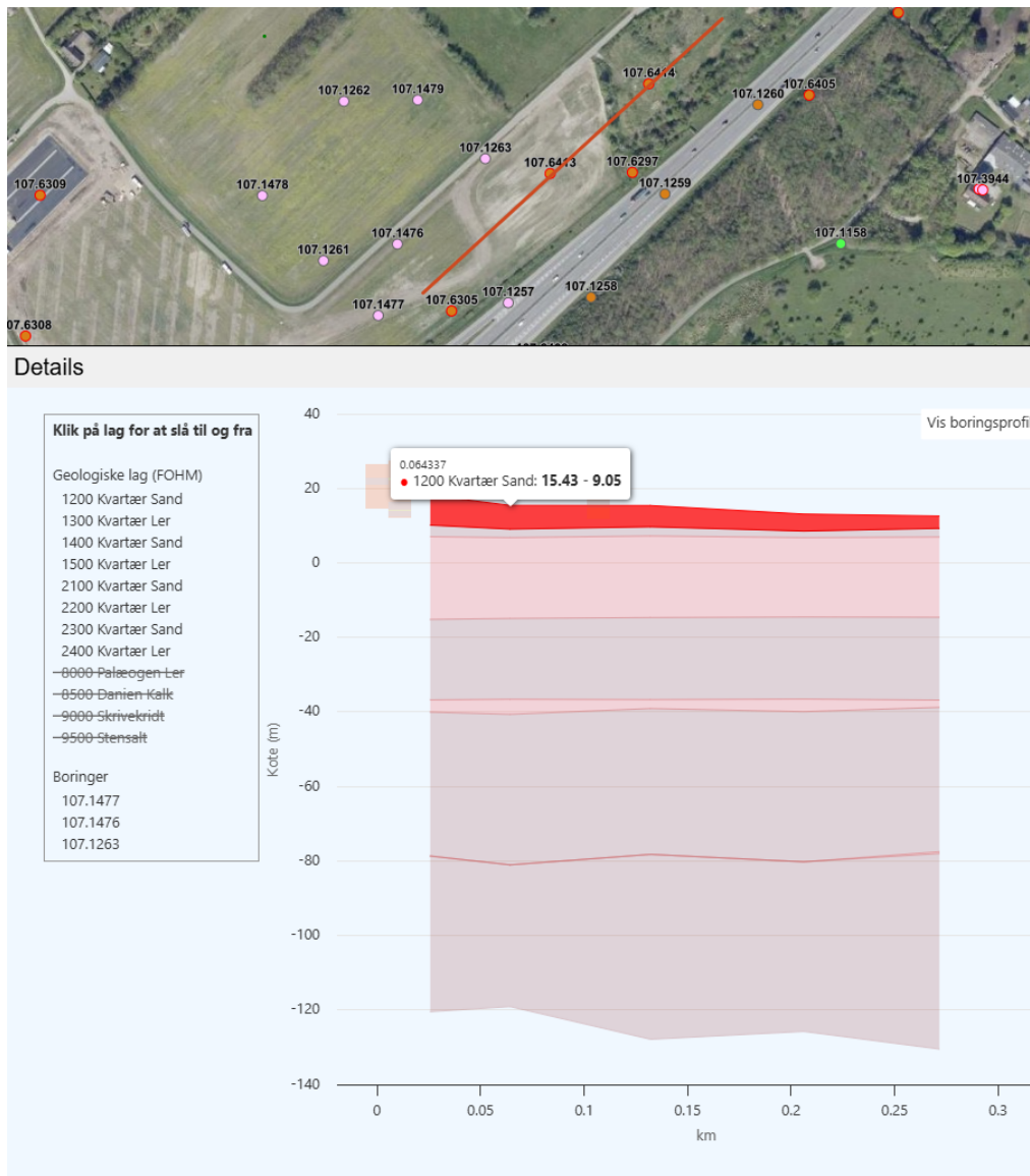
Figur 1.7: Tværsnit gennem bassin med FOHM lag.
