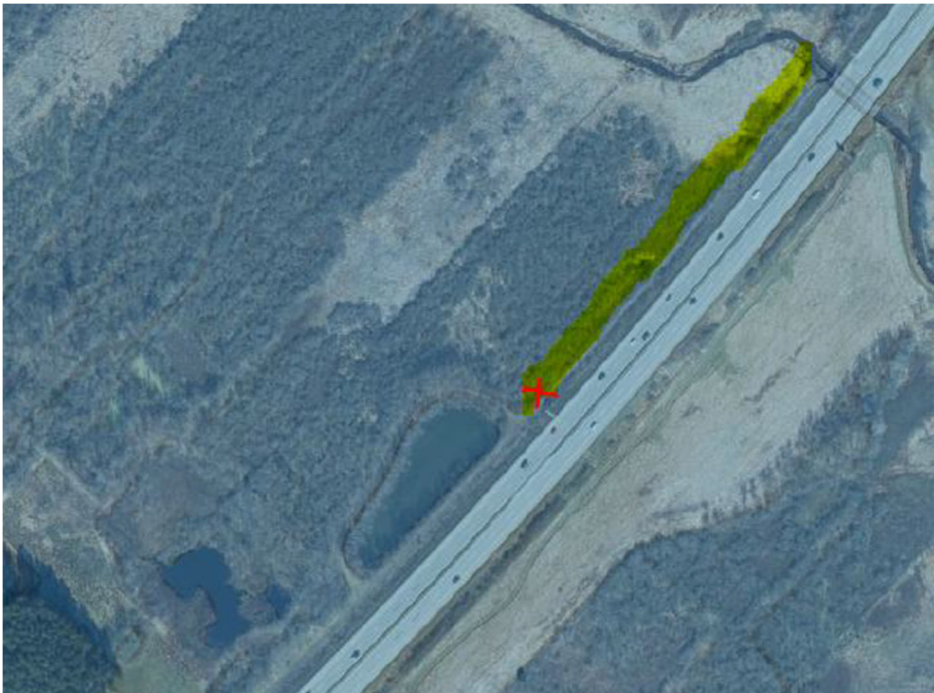
Figur 2. Udledning til St. Hansted Å, hvor rødt kryds angiver udledningspunkt til grøft og gul markering angiver eksisterende grøft
