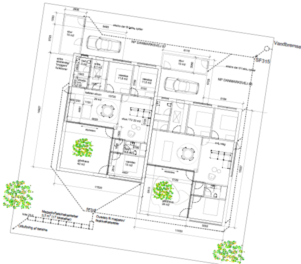
Figur 2: Regnvandsløsning for dobbelthus på N P Danmarksvej 85 og 87, 8752 Hovedgård. Intern forsinkelse i form af faskine placeres på N P Danmarksvej 87, 8752 Hovedgård og vandbremse indstilles til 3,24 l/s.
