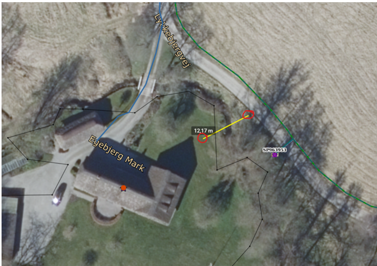
Figur 1. Oversigtskort, klip fra ansøgningsmaterialet. Placering af fiberledningen (gul linje), hvor de røde cirkler markerer borehullernes placering.
