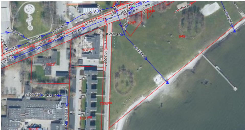
Figur 2: Øverst til venstre ses tilslutningspunkt til intern brønd. Øverst til højre ses tilslutningspunktet (brønd nr. R19R098). Nederst ses regnvandsledningen forløb fra tilslutningspunkt til udløbet i Horsens Fjord (udløb A79UR)
