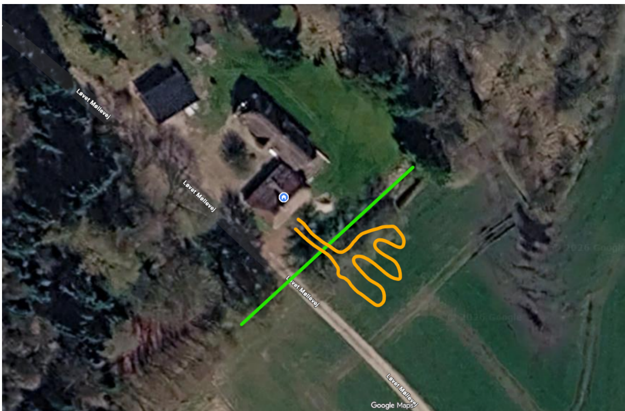
Figur 1. Oversigtskort, klip fra ansøgningsmaterialet. Placering af jordvarmeslangerne (gul markering), hvor den grønne streg markerer tilløbet til Sprækkebjerg Bæk.
