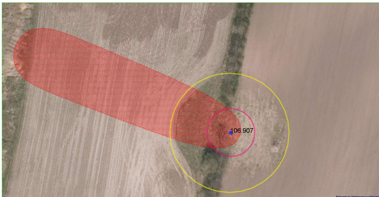
Figur 4 viser de forskellige beskyttelseszoner om en boring - 25 meter (gul), 10 meter (lyserød) og BNBO (rødskraveret).
