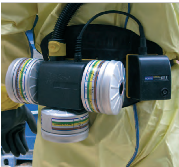
Kombinationsfiltre og motor til åndrætsværn
